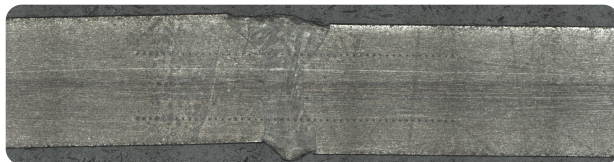
Панорамная съемка с видом измерения твердости
