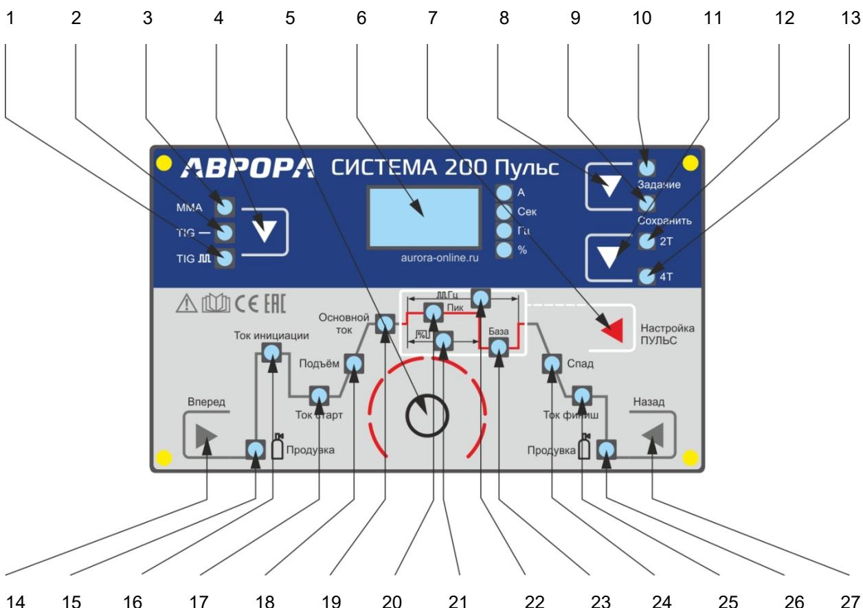
1. Режим «Аргонодуговая сварка с пульсом»
